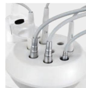
**BIOSTER e FLUSHING.** BIOSTER è il sistema automatico di disinfezione intensiva dei circuiti interni degli spray a mezzo liquido antisettico (Peroxy Ag+). FLUSHING elimina il liquido stagnante nei condotti tramite un rapido risciacquo.
